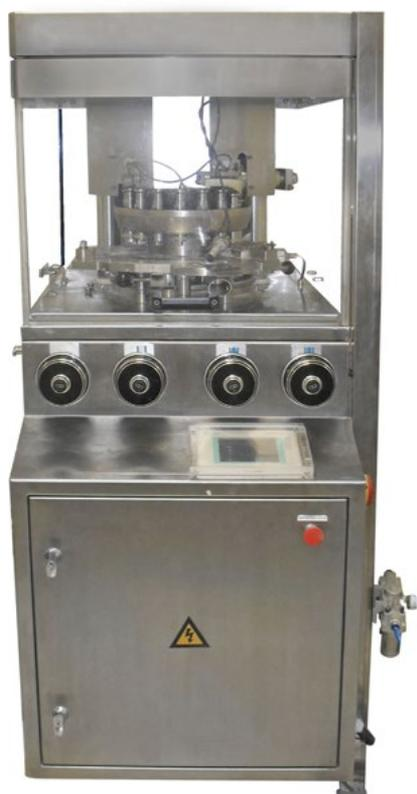
Tableteadoras de rango medio, equipos robustos de fácil operación, confiables y seguros, cuentan con alimentación forzada.
